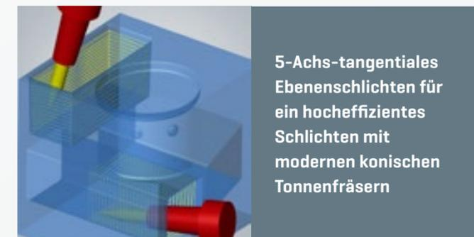
**5-Achs-tangentiales Ebenenschichten für ein hocheffizientes Schlichten mit modernen konischen Tonnenfräsern**
