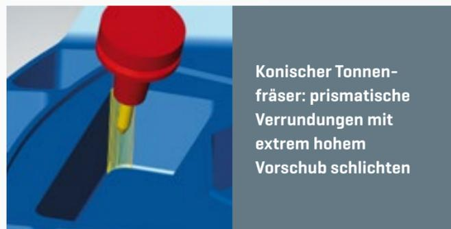
**Konischer Tonnenfräser: prismatische Verrundungen mit extrem hohem Vorschub schlichten**
