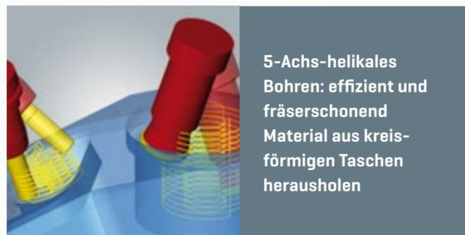
**5-Achs-helikales Bohren: effizient und fräaserschonend**
