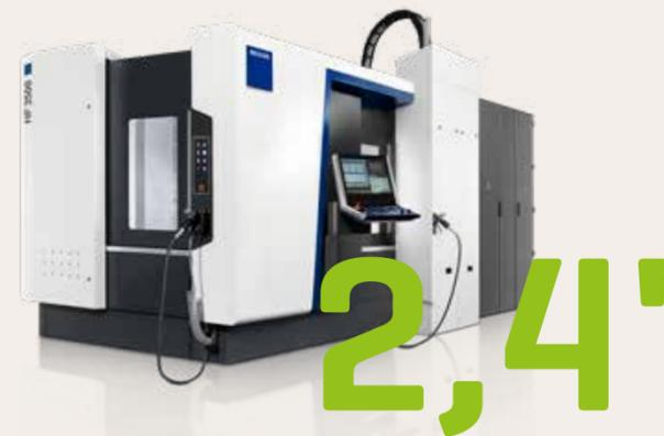
Die Span-zu-Span-Zeit beim Werkzeugwechsel, dem „Boxenstopp der Bearbeitungszentren“, beträgt bei der HF 3500 mit Speed-Paket gerade einmal 2,4 Sekunden. Der schnellste Boxenstopp in der Formel 1 mit nur 2,3 Sekunden gelang 2012 Jenson Button für McLaren.
